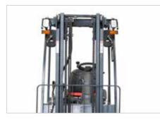
Die übersichtlich angeordneten Hydraulikschläuche und Ketten bieten eine gute Durchsicht nach vorn.
